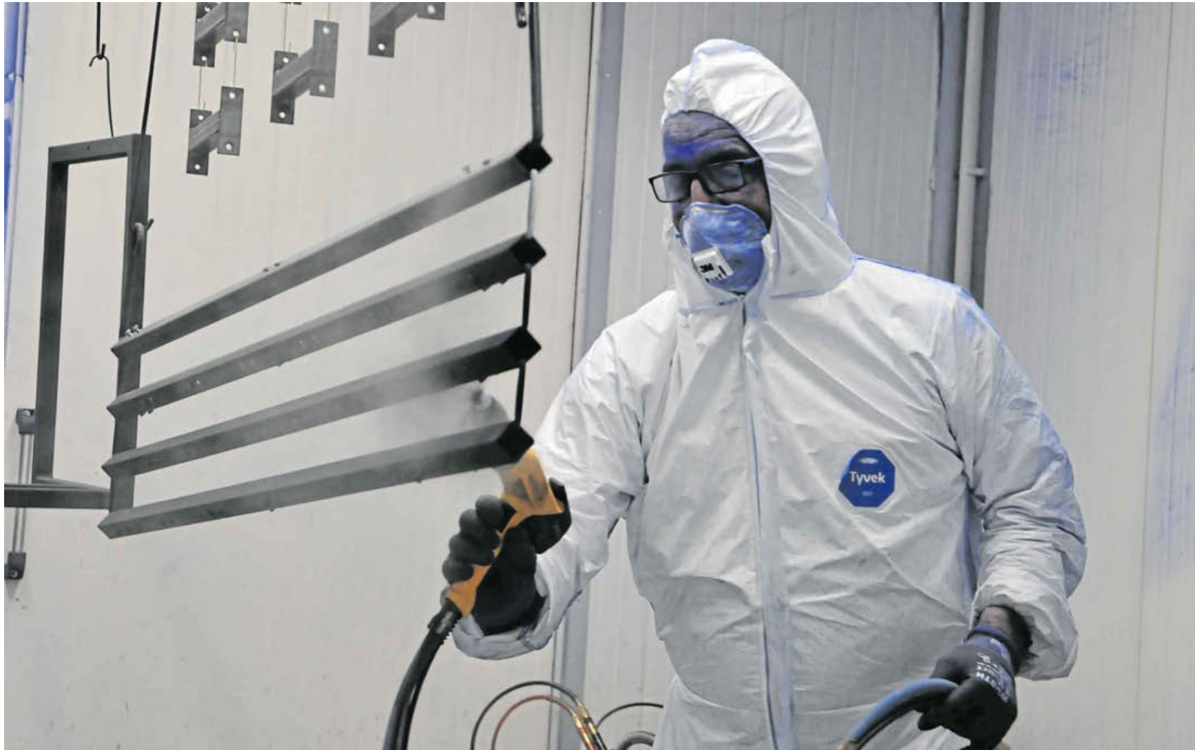
Ein Mitarbeiter im Schutzanzug bei der Pulverbeschichtung von Bauteilen. Das Unternehmen mit Sitz am Otterweg hat in den vergangenen Jahren sehr viel Geld in neue Anlagen wie diese investiert.
